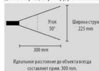
Диаметр отверстия (в данном случае: 0,017 дюйма) определяет объемный расход и, тем самым, количество наносимой краски.
